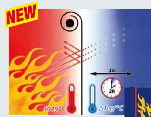
Через 2 часа горения всего лишь 57С в метре от проема (схематический рисунок EW120)
